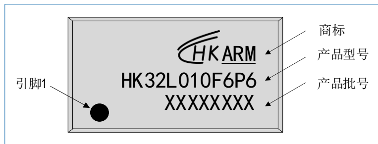
图 7-9 TSSOP20 HK32L010F6P6 丝印示例
