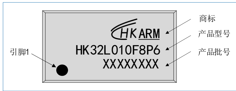
图 7-8 TSSOP20 HK32L010F8P6 丝印示例
